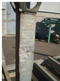
32.10.20 Apgadinta identifikacijos lentelė
