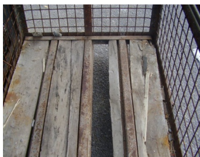
32.10.4 Sulaužytas medinis pagrindas
