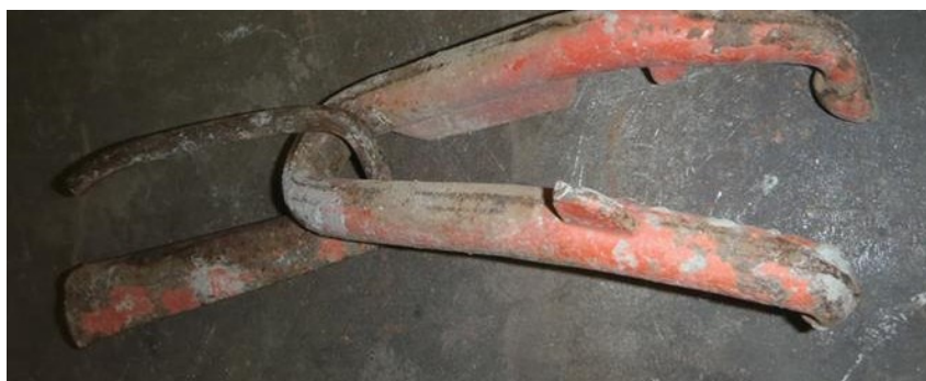
27.84: Pažeista TAR kablo gembė arba pleištas
