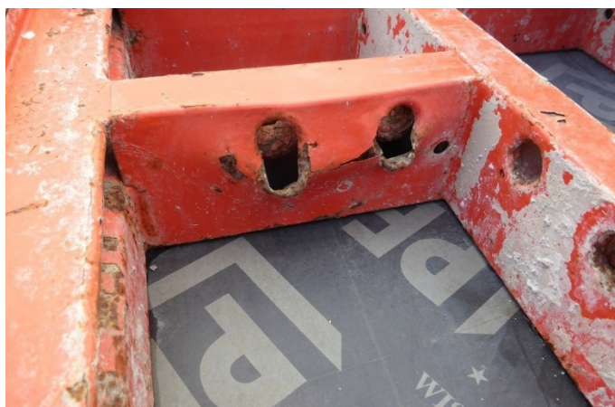
27.2.7: Sulenktas rėmo konstrukcijos elementas
