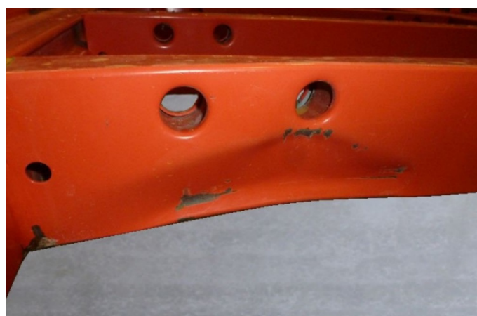
27.2.7: Sulenktas rėmo konstrukcijos elementas
