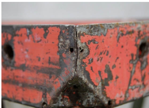
27.2.5: Įtrūkusi suvirinimo siūlė
