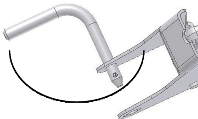
27.103: Trūksta, deformuotas kaištis
