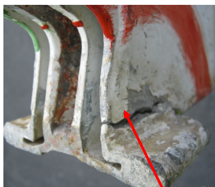
21.12.1: Sulaužyta arba nutrūkusi suvirinimo siūlė per vidinį ir išorinį sijos sluoksnį
