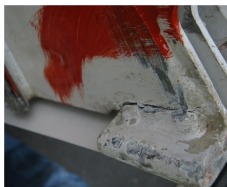
21.12.2: Sulaužyta arba nutrūkusi suvirinimo siūlė tik išoriniame sluoksnyje
