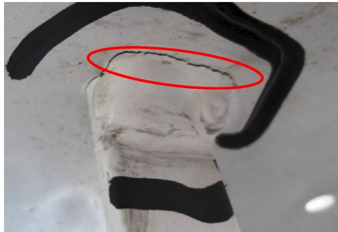
21.2.6: Įtrūkusi atramos suvirinimo siūlė (nepažeista prie atramos)
